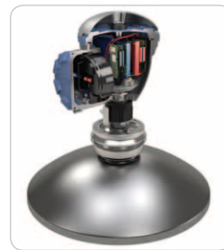
Obr. 2 Funkcia „2 v 1“ – dve úplne nezávislé, galvanicky oddelené elektroniky vysielať cez spoločnú anténu. Snímač hladiny Raptor tak poskytuje doteraz najvyššiu úroveň integrity bezpečnosti, aký bol pri hladinomeroch použitý – SIL 3.
